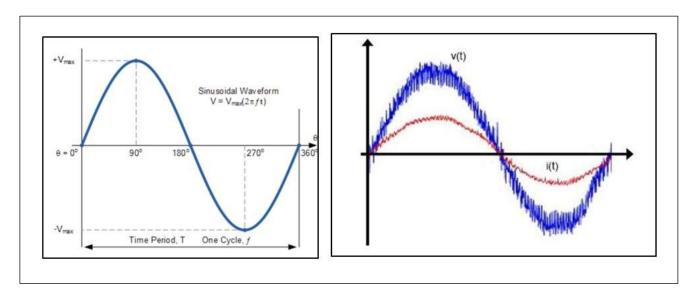
**Bilder Seite 16 unten:** Links eine saubere Sinuskurve. Rechts hochfrequent verseuchter Sinus
