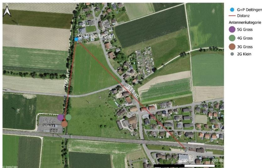
Abbildung 44: Mobilfunkantennenstandorte in der näheren Umgebung der Dauermessstation in Deitingen, klassiert nach Mobilfunkstandard und Sendeleistung [21]. Die roten Distanzlinien sind als kürzeste horizontale Abstände zwischen der Antenne und dem Feldstärkesensor aufzufassen. Höhenunterschiede werden nicht berücksichtigt. Da keine Informationen über die azimutale Ausrichtung der Antennensektoren vorliegen, ist eine Beitragsabschätzung einzelner Antennen unmöglich.
